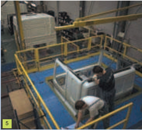
Figuur 5. Lijmen hoogdak op cabine DAF CF.
